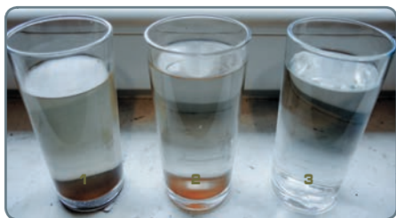
ПОСЛЕ ТРЕХ СУТОК ОТСТАИВАНИЯ ПРОБЫ ГОРЯЧЕЙ ВОДЫ 1. Отстой дренажа ГИГ. 2. Отстой воды после ГИГ. 3. Вода после ФТО.
